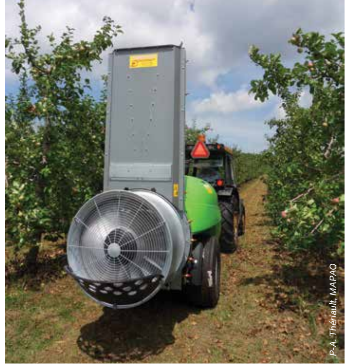
Figure 4.21 Pulvérisateur à jet
